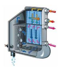
Der Arcticstar ist exklusiv mit flexiblen Scrollkompressoren (ab Modell AS0720) ausgestattet und bietet im Vergleich mit anderen Systemen Energieeinsparungen bis 20%. Resistent gegen Kühlmittel-Rückfluss und mit 50% weniger beweglichen Teilen als ähnliche Anlagen sind diese Kompressoren extrem zuverlässig und äußerst robust. Auch niedrige Vibrationsniveaus tragen zur Verlängerung der Lebensdauer des Kühlkreislaufs bei.
